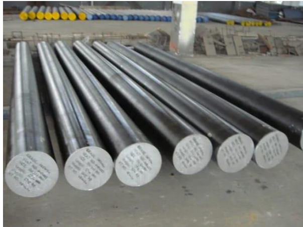
Сурет 2 – Прокаттан жасалған дайындамалар 20 конструкторлық легірленген болат сипаттамасы
